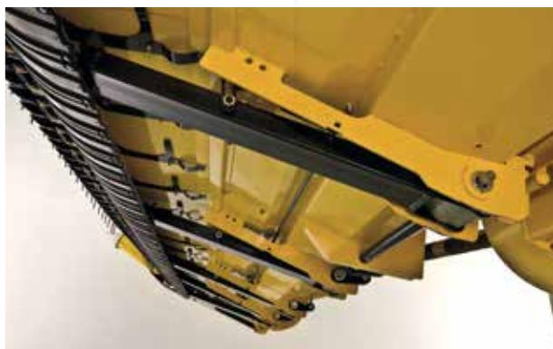
Um bloco de torção totalmente ajustável, localizado entre a armação principal e o braço de apoio, controla e mantém a pressão sobre o solo da barra de corte.
